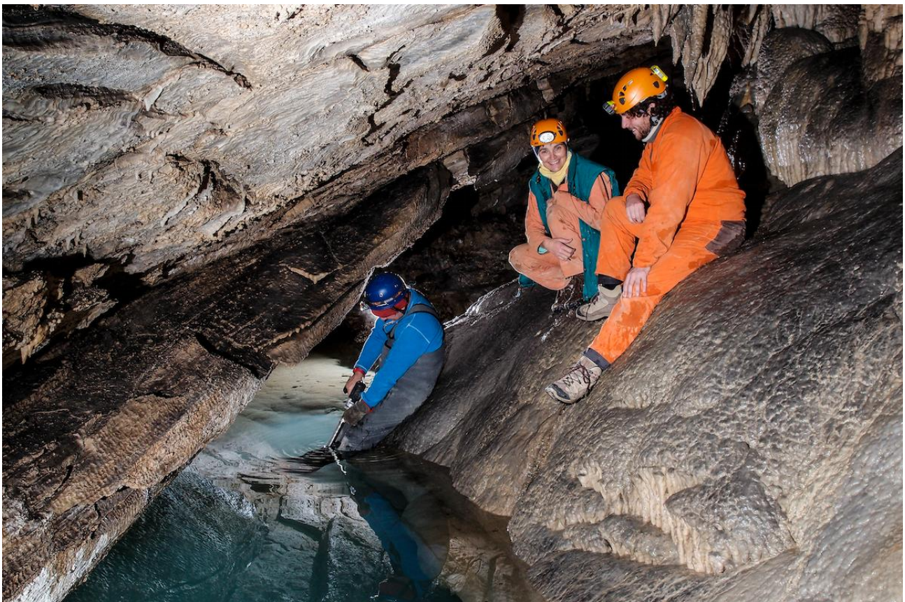
Foto scattata all'interno dell'Antro del Corchia a 400 m sotto la superficie con ricercatori del Dipartimento di Scienze della Terra e Istituto Nazionale di Geofisica e Vulcanologia che stanno effettuando un carotaggio in una concrezione subacquea per ricostruire il clima passato. Questo genere di studi hanno reso famose le grotte Apuane in tutto il mondo per le importanti ricostruzioni climatiche ottenute. (Foto L. Cesari)
